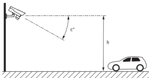
A ilustração mostra o tilt angle (ângulo de inclinação)(c) para baixo do dispositivo e mounting height (altura de montagem) (h) medida do aterrado até o dispositivo.
