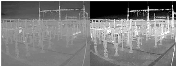
**Brightness (Brillo):** Utilice el control deslizante para ajustar la intensidad de la luz. Esto puede hacer que los objetos sean más fáciles de ver. El brillo se aplica después de capturar la imagen y no afecta a la información de la imagen. Para obtener más detalles de una zona oscura, normalmente es mejor aumentar la ganancia o el tiempo de exposición.
