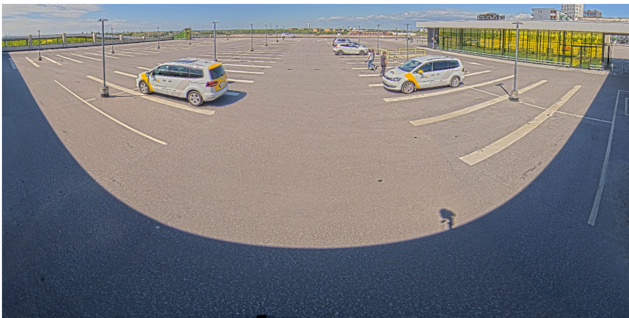
Captura de una vista panorámica de 180 grados realizada con una cámara multisensor con enderezamiento del horizonte. El horizonte está vertical y los objetos verticales también.
