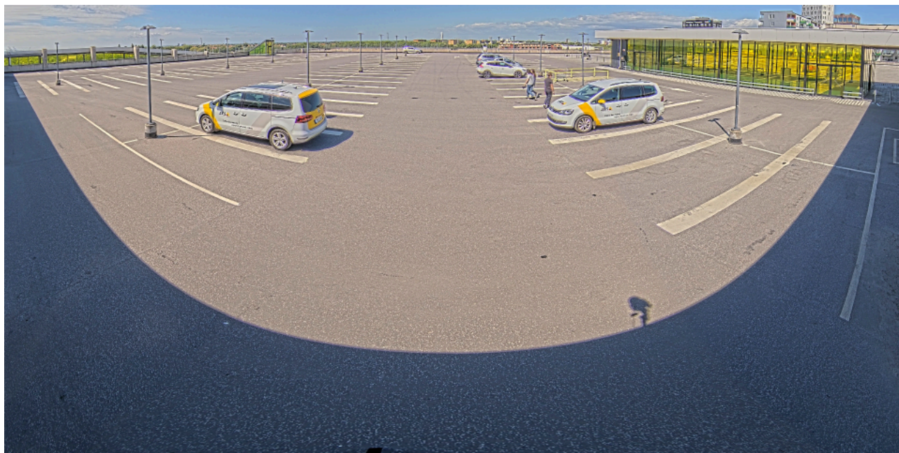
Vue panoramique à 180 degrés prise avec une caméra multicapteur avec redressement de l'horizon. L'horizon est droit et les objets verticaux sont verticaux.
