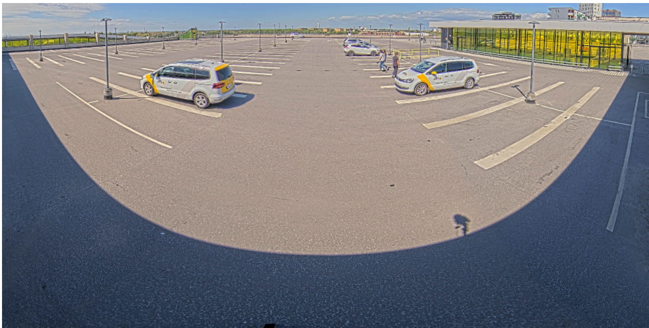
Istantanea di una vista panoramica a 180 gradi con una telecamera multisensore con raddrizzamento dell'orizzonte. L'orizzonte è dritto e gli oggetti verticali sono verticali.
