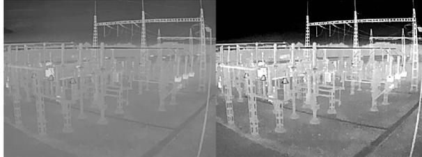
**Helligkeit:** Stellen Sie mithilfe des Schiebereglers die Lichtstärke ein. Dadurch lassen sich Objekte leichter erkennen. Helligkeit wird nach der Bildaufnahme angewendet und hat keine Auswirkungen auf die Bilddaten. Um mehr Details aus dunklen Bereichen zu erhalten, ist es normalerweise besser, die Verstärkung oder die Belichtungszeit zu erhöhen.
