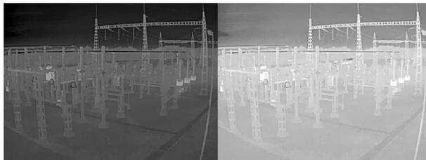
**Schärfe:** Stellen mithilfe des Schiebereglers den Randkontrast ein, um Objekte in einem Bild schärfer darzustellen. Wenn Sie die Schärfe erhöhen, kann dies zu einer höherem Bitrate und einem höheren Bedarf an Speicherplatz führen.
