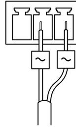
**Conector de alimentação** – Conector de energia CA e CC para conexão aos fios do AXIS T8051 Power Converter AC/DC to DC (não incluído).
