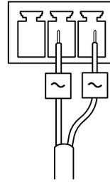
电源连接器 – 用于 AC 和 DC 电源的连接器，用于连接到未包含的 AXIS T8051 电源转换器 AC/DC 至 DC 电线。
