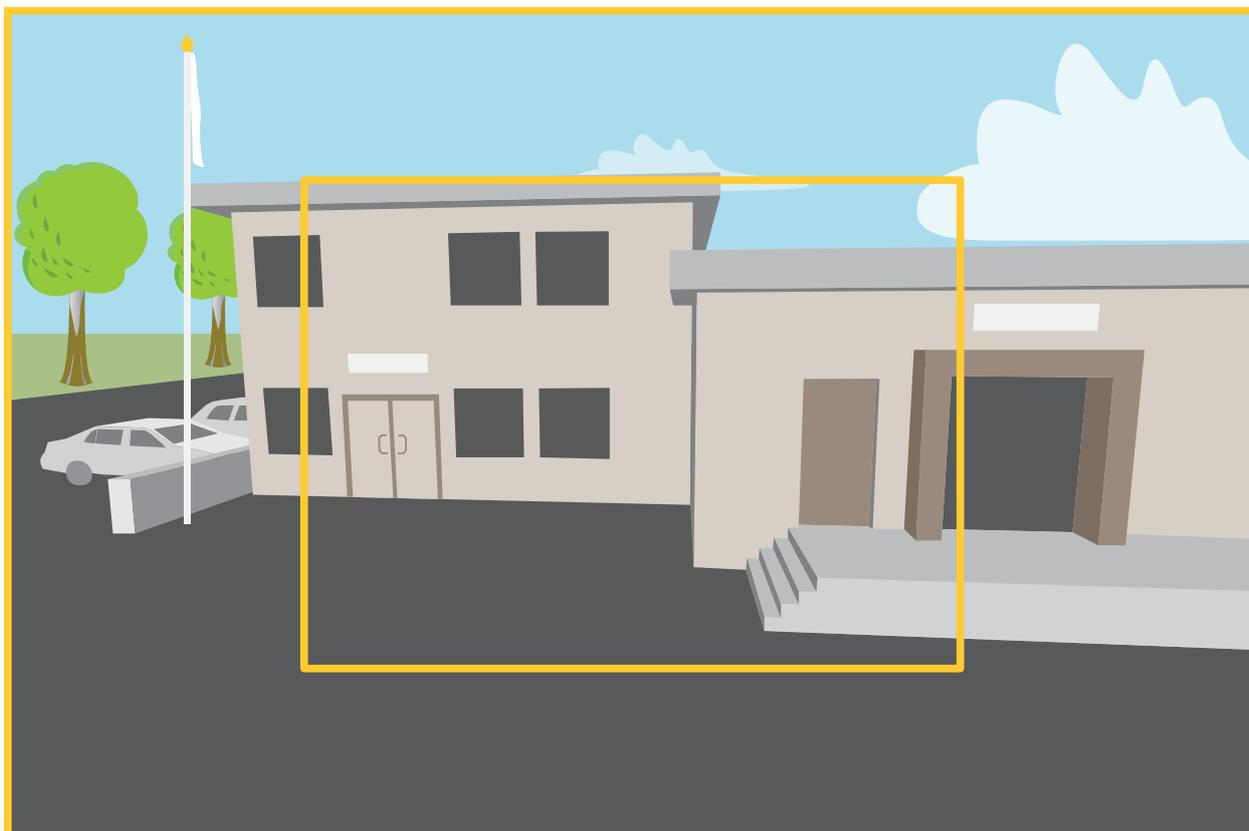
A imagem mostra como o campo de visão e a proporção podem ser alterados entre dois modos de captura diferentes. O modo de captura a ser escolhido depende dos requisitos da taxa de quadros e resolução para a configuração de monitoramento específica. Para obter especificações sobre os modos de captura disponíveis, consulte a folha de dados em [axis.com](http://axis.com).
