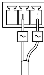
**Conector de energia** – Conector de energia CA e CC para conexão aos fios do AXIS T8051 Power Converter AC/DC to DC (não incluído).
