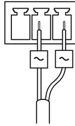
電源接頭 - 用於連接不包含的 AXIS T8051 電源轉換器 AC/DC 到 DC 電線的 AC 和 DC 連接器。
