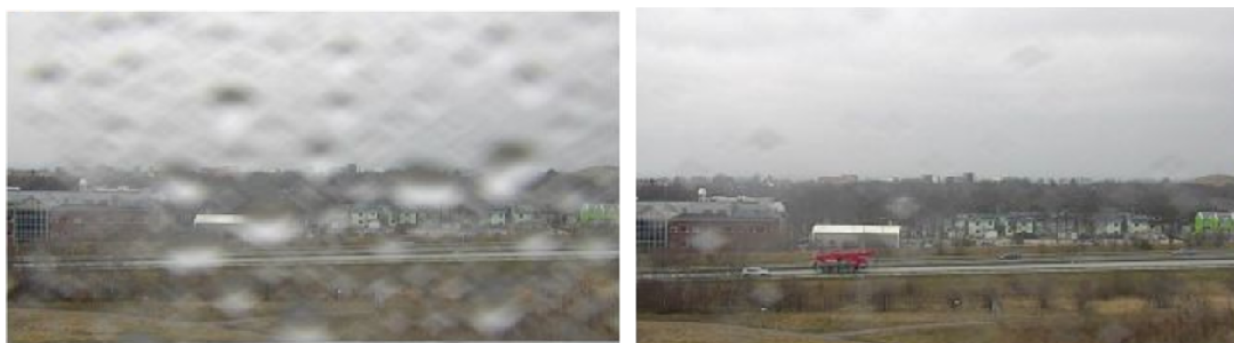
Instantánea de la vista en vivo de una cámara antes y después de que se haya activado el secado rápido.
