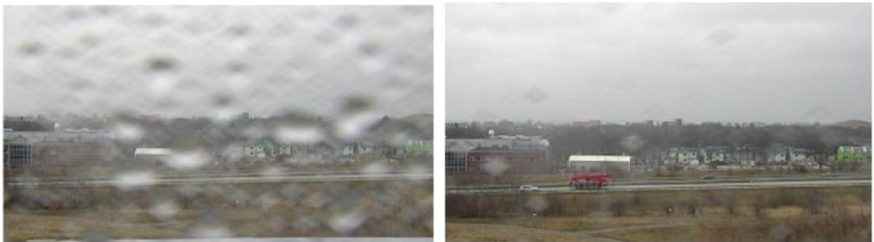
Ujęcie z podglądu na żywo z kamery przed i po aktywacji funkcji szybkiego suszenia.
