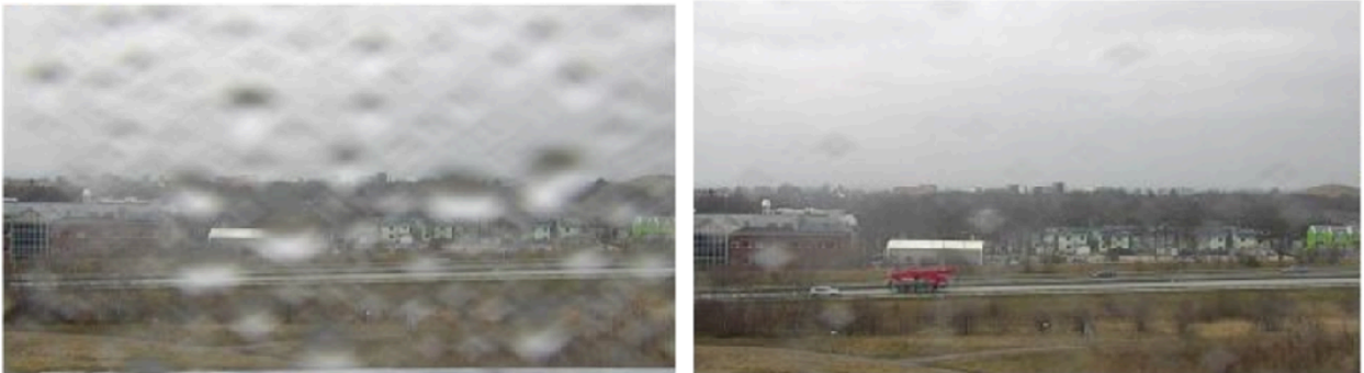
Schnappschuss aus der Live-Ansicht einer Kamera bevor und nachdem die Speed-Dry-Funktion aktiviert wurde.
