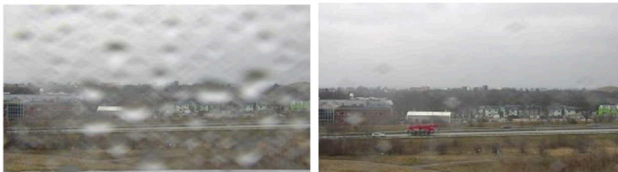
Capture d'image de la vidéo en direct d'une caméra avant et après l'activation de la fonction de séchage rapide.
