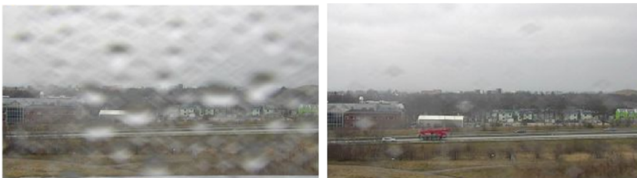
Istantanea dalla visualizzazione in diretta della telecamera prima e dopo l'attivazione della funzione Speed Dry.
