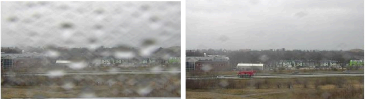
スピードドライを作動させる前と後のカメラのライブビューからのスナップショット。
