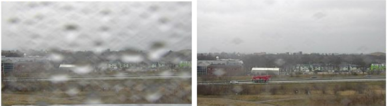
Speed Dry 전과 후 카메라 실시간 보기의 스냅샷이 활성화되었습니다.
