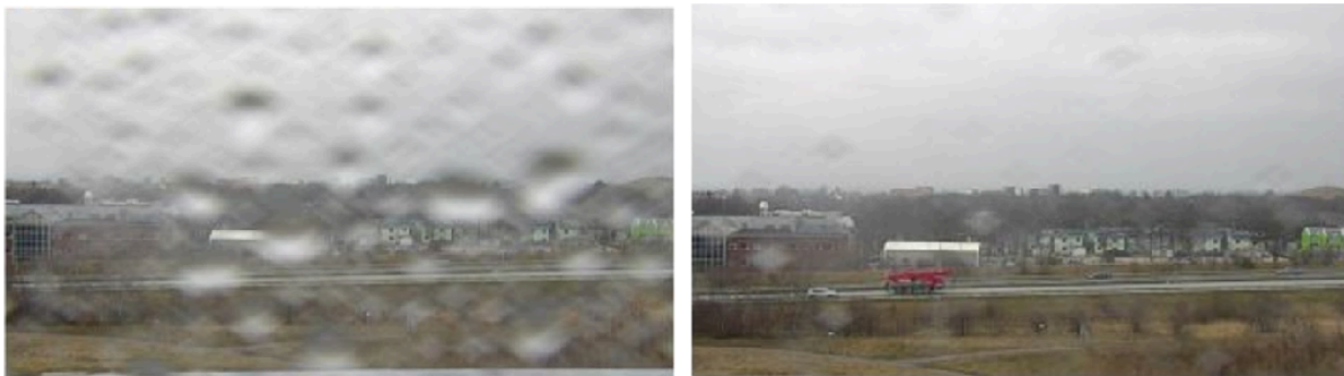
Ujęcie z podglądu na żywo z kamery przed i po aktywacji funkcji szybkiego suszenia.
