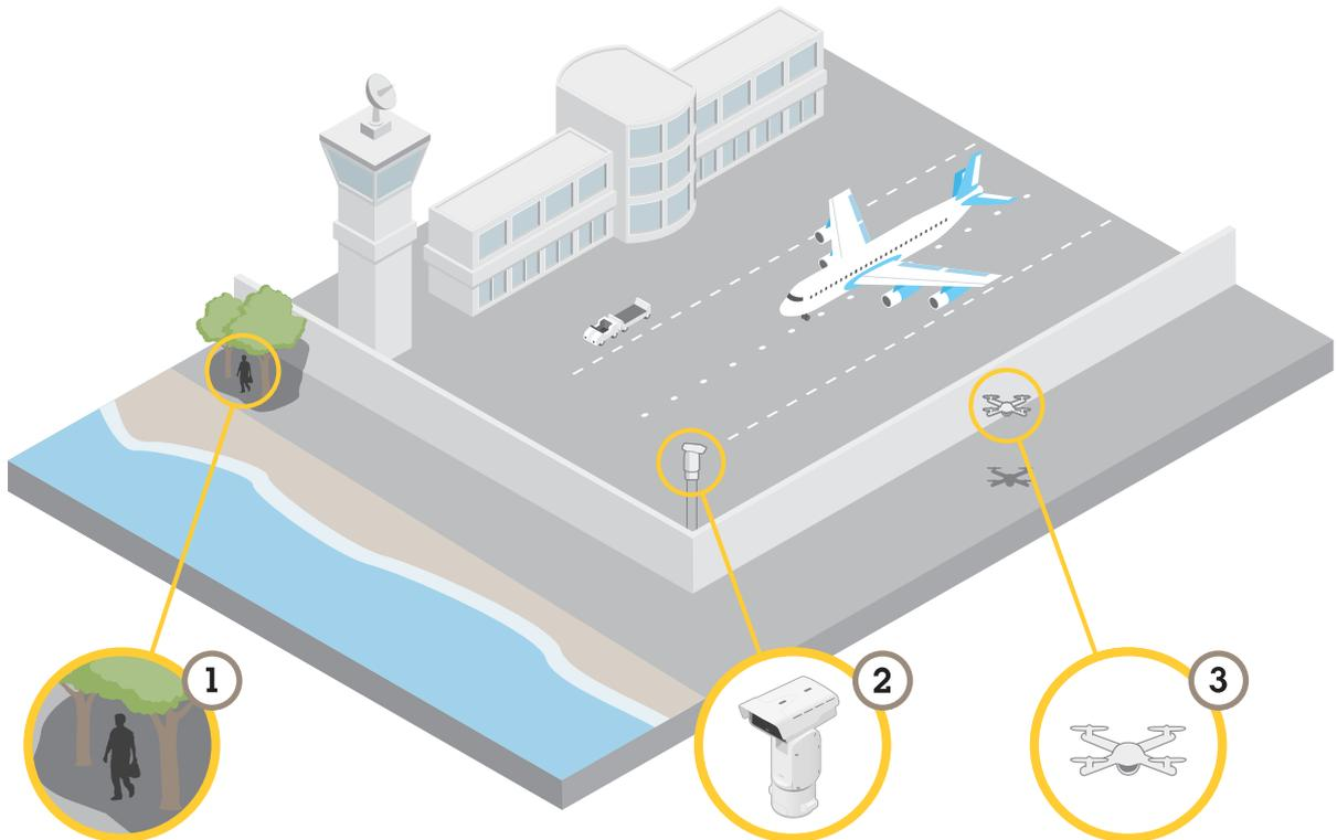
Bei schwierigen Lichtverhältnissen kann der Wärmebildkanal Objekte (1) erfassen, die der optische Sensor nicht erkennt. Um diese Funktion zu nutzen, können Sie den Wärmebildkanal so einrichten, dass er Bewegungen automatisch erfasst und dann zum Heranzoomen und Aufzeichnen ein Signal an den optischen Bildkanal sendet. Weitere Informationen finden Sie hier: [Seite 13](#)
