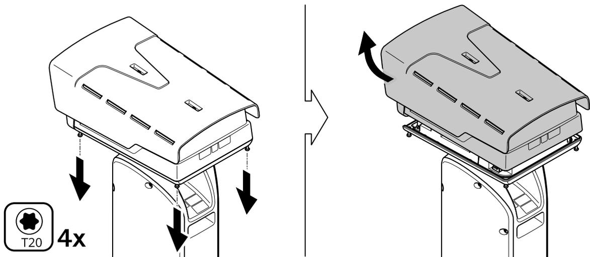
2. Lösen Sie die vier Schrauben der oberen Abdeckung, und nehmen Sie die Abdeckung ab.
