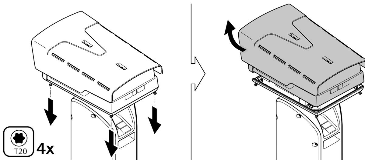
2. Afloje los cuatro tornillos de la cubierta superior y retírela.
