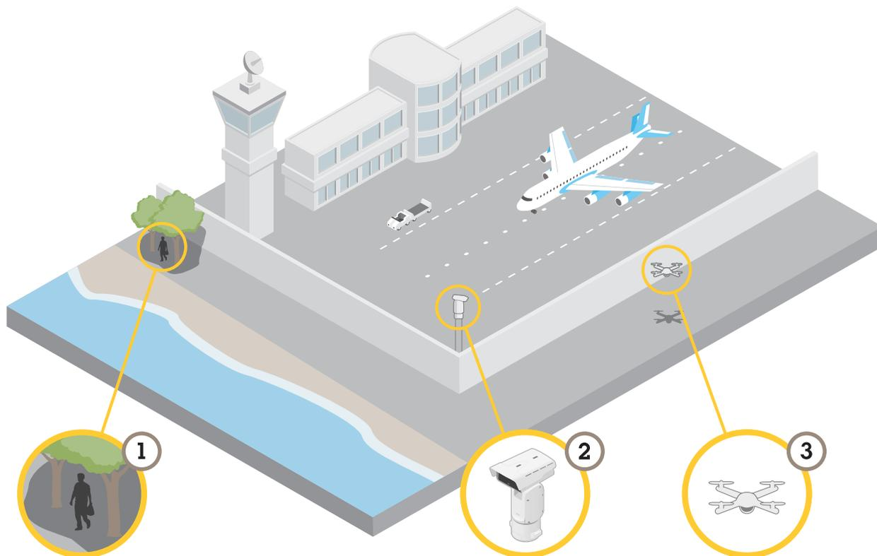
En condiciones de iluminación difíciles, el canal térmico puede detectar objetos (1) que el canal visual no puede. Para aprovecharlo, puede configurar el canal térmico para que detecte automáticamente el movimiento y envíe una señal al canal visual para hacer zoom y grabar. Para más información, vaya a .
