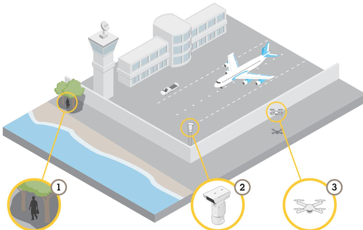
In condizioni di illuminazione difficili, il canale termico può rilevare oggetti (1) che il canale visivo non è in grado di rilevare. Per sfruttare questa funzione, è possibile impostare il canale termico in modo che rilevi automaticamente il movimento e invii un segnale al canale visivo per lo zoom e la registrazione. Per ulteriori informazioni, consultare .
