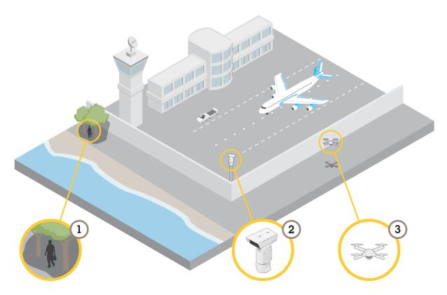
Em condições de iluminação difíceis, o canal térmico pode detectar objetos (1) que o canal visual não consegue detectar. Para tirar proveito disso, você pode configurar o canal térmico para detectar movimento automaticamente e enviar um sinal ao canal visual para dar zoom e gravar. Para saber mais, acesse .
