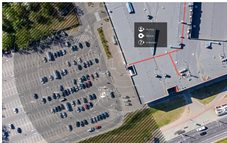
Beispiel für eine Referenzkarte im AXIS D2110-VE Security Radar.
