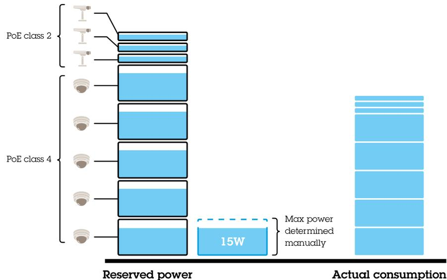
要求された電力は、PoE Class4デバイスの場合は手動で20 Wに調整されます。スイッチは、5つのPoE Class4デバイスと3つのPoE Class2デバイスに電力を供給できます。要求される合計電力は $(5 \times 20) + (3 \times 7) = 121$  Wです。実際の消費電力は $(5 \times 15) + (3 \times 5) = 90$  Wです。このようにして、接続されているすべてのデバイスに十分な電力が保証され、優先順位はそれほど重要ではありません。
