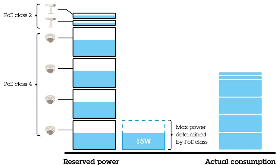
各デバイスによって要求される電力は、PoE Classによって決まります。スイッチは、4つのPoE Class4デバイスと2つのPoE Class2デバイスに電力を供給できます。要求される合計電力は  $(4 \times 30) + (2 \times 7) = 134$  Wです。実際の消費電力は  $(4 \times 15) + (2 \times 5) = 70$  Wです。このようにして、接続されているすべてのデバイスに十分な電力が保証され、優先順位はそれほど重要ではありません。
