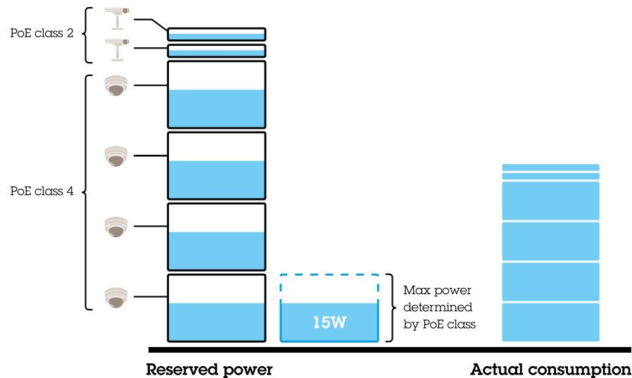
Мощность, запрошенная каждым устройством, определяется классом PoE. Коммутатор может подавать питание на четыре устройства PoE класса 4, а также на два устройства PoE класса 2. Общий объем запрашиваемой мощности составляет  $(4 \times 30) + (2 \times 7) = 134$  Вт. Фактическая потребляемая мощность составляет  $(4 \times 15) + (2 \times 5) = 70$  Вт. Таким образом, все подключенные устройства гарантированно получат необходимый объем мощности и в этом случае приоритет менее важен.
