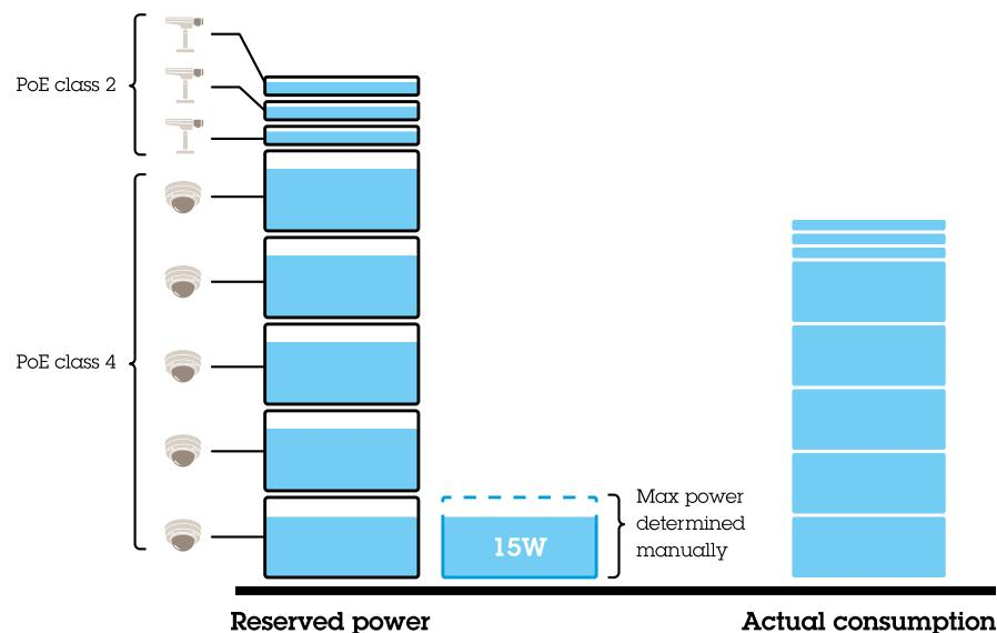
Запрашиваемая мощность задается вручную и составляет 20 Вт для устройств PoE класса 4. Коммутатор может подавать питание на пять устройств PoE класса 4, а также на три устройства PoE класса 2. Общий объем запрашиваемой мощности составляет  $(5 \times 20) + (3 \times 7) = 121$  Вт. Фактическая потребляемая мощность составляет  $(5 \times 15) + (3 \times 5) = 90$  Вт. Таким образом, все подключенные устройства гарантированно получат необходимый объем мощности и в этом случае приоритет менее важен.
