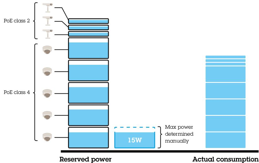
La puissance demandée est ajustée manuellement à 20 W pour les appareils de catégorie 4 PoE. Le commutateur peut alimenter 5 périphériques de catégorie 4 PoE et 3 périphériques de catégorie 2 PoE. La puissance totale requise est de  $(5 \times 20) + (3 \times 7) = 121$  W. La puissance réelle consommée est  $(5 \times 15) + (3 \times 5) = 90$  W. De cette façon, tous les périphériques connectés disposent de suffisamment de puissance et la priorité est moins importante.
