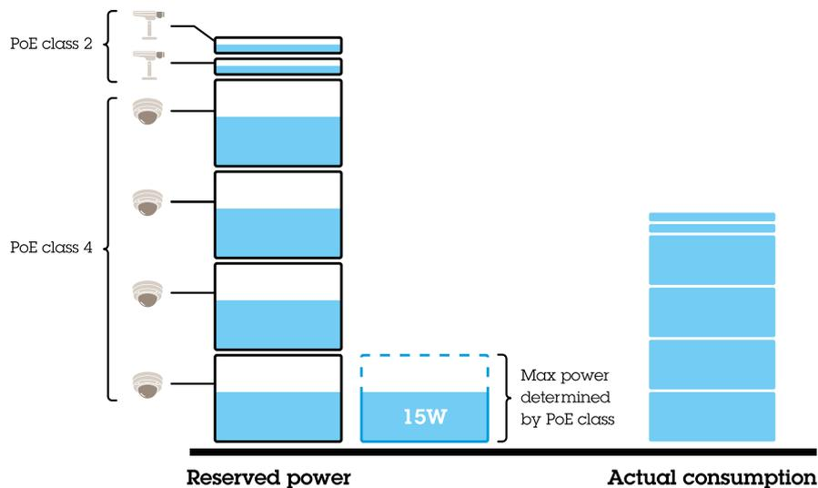
각 장치에서 요청한 전력은 PoE 클래스별로 결정됩니다. 스위치는 PoE 클래스 4 장치 4개 및 PoE 클래스 2 장치 2개에 전력을 공급할 수 있습니다. 요청된 총 전력은  $(4 \times 30) + (2 \times 7) = 134W$ 입니다. 실제 소비된 전력은  $(4 \times 15) + (2 \times 5) = 70W$ 입니다. 이러한 방식으로 연결된 모든 장치에 전력이 충분히 보장되며 우선 순위는 덜 중요합니다.
