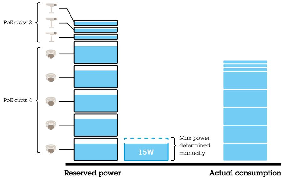
PoE 클래스 4 장치의 경우 요청된 전력은 수동으로 20W로 조정됩니다. 스위치는 PoE 클래스 4 장치 5개 및 PoE 클래스 2 장치 3개에 전력을 공급할 수 있습니다. 요청된 총 전력은  $(5 \times 20) + (3 \times 7) = 121\text{W}$ 입니다. 실제 소비된 전력은  $(5 \times 15) + (3 \times 5) = 90\text{W}$ 입니다. 이러한 방식으로 연결된 모든 장치에 전력이 충분히 보장되며 우선 순위는 덜 중요합니다.
