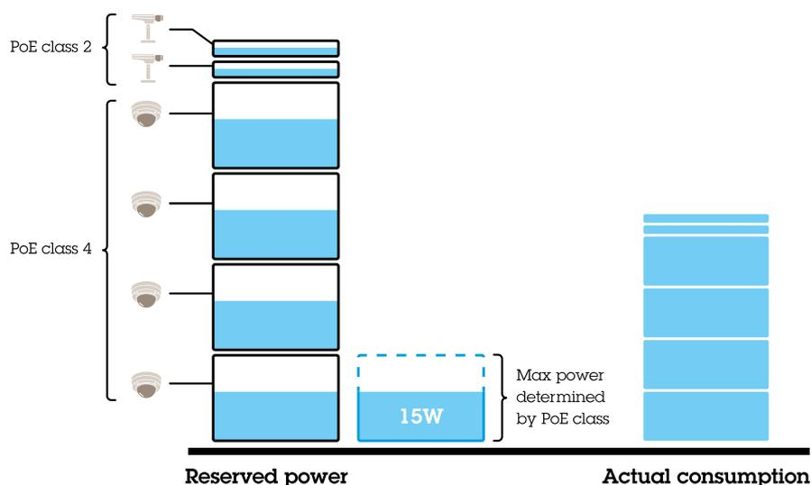
Мощность, запрошенная каждым устройством, определяется классом PoE. Коммутатор может подавать питание на четыре устройства PoE класса 4, а также на два устройства PoE класса 2. Общий объем запрашиваемой мощности составляет  $(4 \times 30) + (2 \times 7) = 134$  Вт. Фактическая потребляемая мощность составляет  $(4 \times 15) + (2 \times 5) = 70$  Вт. Таким образом, все подключенные устройства гарантированно получают необходимый объем мощности и в этом случае приоритет менее важен.
