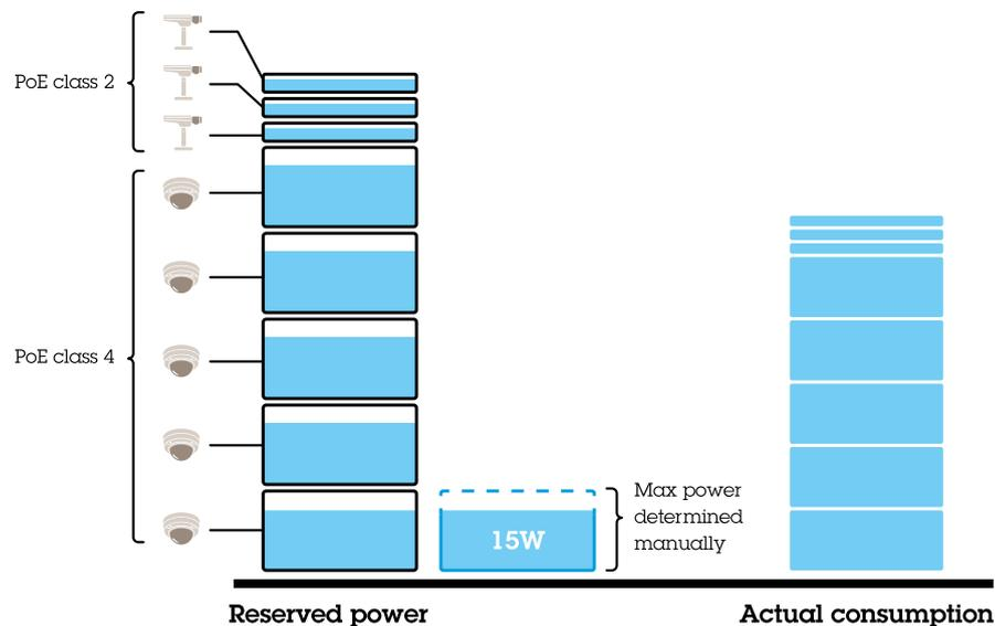
La potencia solicitada se ajusta manualmente a 20 W para los dispositivos PoE clase 4. El switch puede alimentar 5 dispositivos PoE clase 4 y 3 dispositivos PoE clase 2. La potencia total solicitada es  $(5 \times 20) + (3 \times 7) = 121$  W. La potencia real consumida es  $(5 \times 15) + (3 \times 5) = 90$  W. De esta manera, todos los dispositivos conectados tienen garantizada una potencia suficiente y la prioridad es menos importante.
