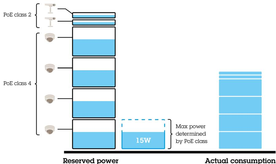
La potencia en vatios requerida por cada dispositivo se determina por la clase de PoE. El switch puede alimentar 4 dispositivos PoE clase 4 y 2 dispositivos PoE clase 2. La potencia total solicitada es  $(4 \times 30) + (2 \times 7) = 134$  W. La potencia real consumida es  $(4 \times 15) + (2 \times 5) = 70$  W. De esta manera, todos los dispositivos conectados tienen garantizada una potencia suficiente y la prioridad es menos importante.
