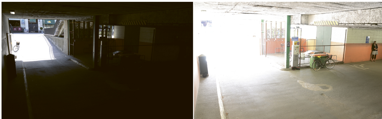
具有宽动态范围的典型监控场景：带入口的停车场内部。两张图像的曝光时间不同，左侧图像时间较短，右侧图像时间较长。
