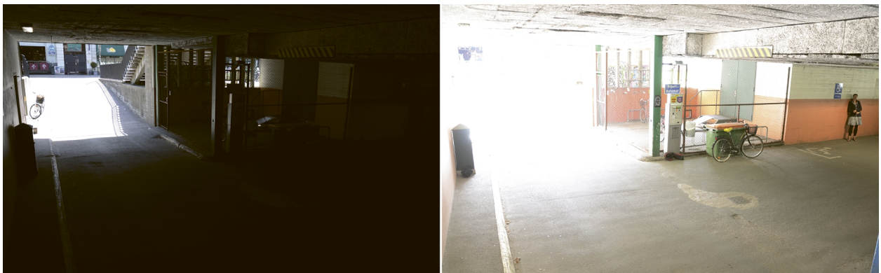
Eine typische Überwachungsszene mit einem großen Dynamikbereich: die Einfahrt eines Parkhauses. Die zwei Bilder wurden mit unterschiedlichen Belichtungszeiten aufgezeichnet, einer kürzeren für das Bild links und einer längeren für das Bild rechts.
