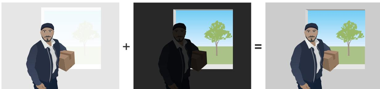
*En las dos primeras imágenes se ve cómo el rango dinámico en la escena supervisada hace que haya partes de la imagen con exposición excesiva o insuficiente. En la tercera imagen, se ha utilizado la captura dinámica WDR, por lo que es una imagen equilibrada con todas las áreas visibles.*
