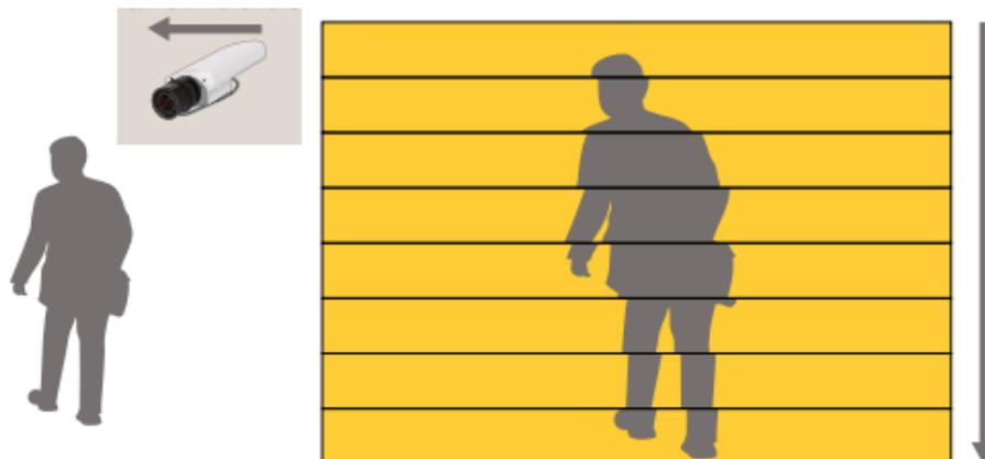
ローリングシャッターの歪みの原理。画像の上から下に向かってラインごとにスキャンされます。ラインがスキャンされている間に振動によってカメラがわずかに左に動くと、画像が歪んでしまいます。
