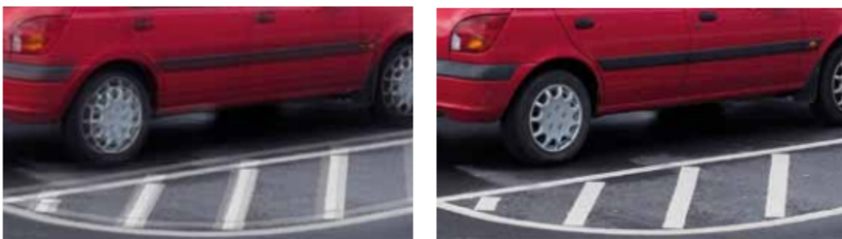
模拟图像。 左：未启用电子图像稳定时的近景照，同时存在水平和垂直运动模糊。 右：启用了电子图像稳定时振动摄像机的抓拍照。
