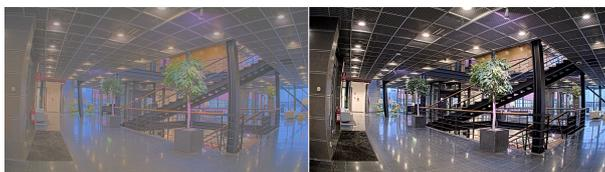
**Luminosité** : Utilisez le curseur pour ajuster l'intensité lumineuse. Cela peut rendre les objets plus visibles. La luminosité est appliquée après la capture de l'image et n'affecte pas les informations contenues dans l'image. Pour obtenir davantage de détails d'une zone sombre, il est parfois préférable d'accroître le gain ou le temps d'exposition.
